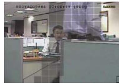
Quando viene rilevato un movimento, sarà possibile vedere le griglie lampeggiare.
