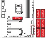
1xM.2 PCIe SSD + 2xSATAe HDDs + 2xSATA HDDs
