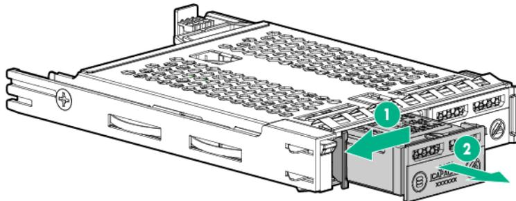
To remove the drive carrier:
