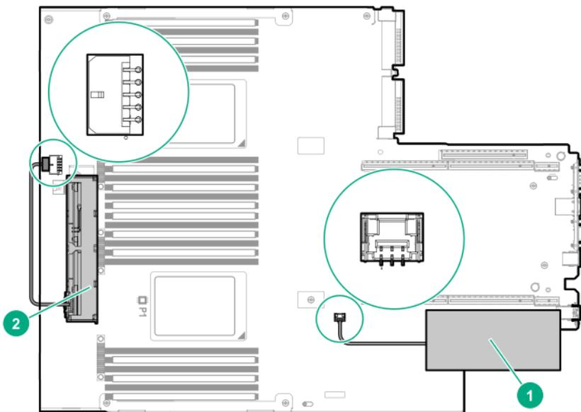
c. Install the center fan baffle.
