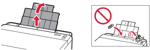
2 Abra la cubierta de la ranura de alimentación y deslice la guía del papel del lado derecho totalmente hacia la derecha.
