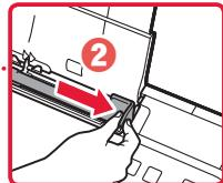
3 Coloque várias folhas de papel com o lado a ser impresso virado para cima e deslide a guia do papel lateral em direção à borda da pilha de papel.
