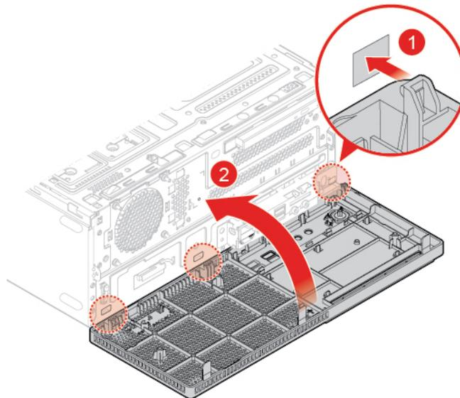
Figure 25. Installing the front bezel
