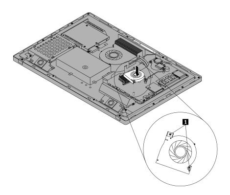
Figure 45. Installing the GPU fan
